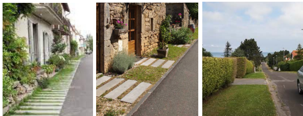
Exemples de bandes piétonnes enherbées revêtues ou non / chevauchables par l'automobile
